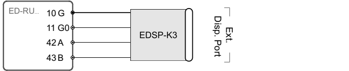
Fig. 2 Raccordement avec un câble EDSP-K3
